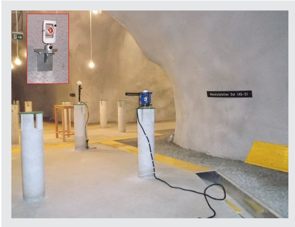
Afbeelding 23 : details van de installatie. De inzet toont een «hoekkubus» op 50 meter van AUTODIF verwijderd, die de laserstraal door AUTODIF gezonden, weerkaatst. Dit dient als een richtingverwijzing.
