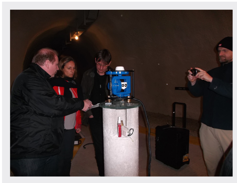
Afbeelding 24 : ideeënuitswisseling tussen wetenschappers van ZAMG en ir. Bracke van het KMI tijdens de installatie van AUTODIF. Let op de blauwe hoes die het instrument beschermt tegen stof en vocht.
